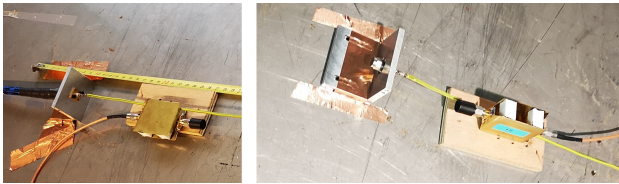
Fig. 8. Définition des orientations horizontale (à gauche) et verticale (à droite) de la sonde par rapport à la ligne excitée.
