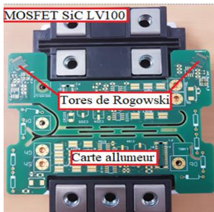
Fig. 8 : Module de puissance industriel LV100 avec capteurs de champ magnétique (Tore Rogowski)
