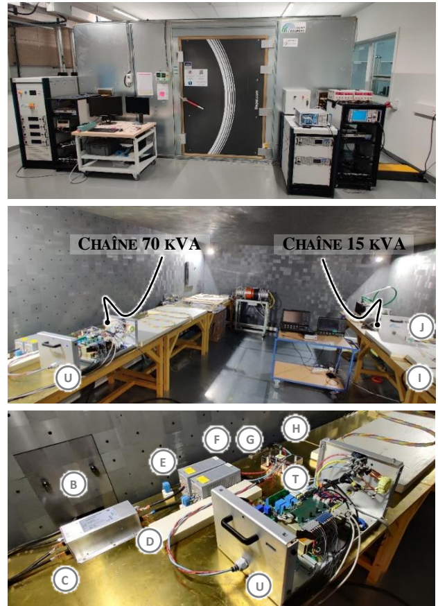
Fig. 4 Mise en parallèle de deux chaînes
