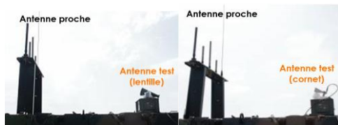
Figure 2. Exemple de mesure de découplage avec deux types d'antenne test
