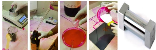
Fig.8. Dosage de la RhB, dilution dans l'éthanol, mélange avec la résine puis dépôt sur le film mince.
